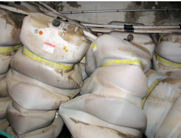
Zerstörte Heizöltanks infolge einer Hochwassereinwirkung
