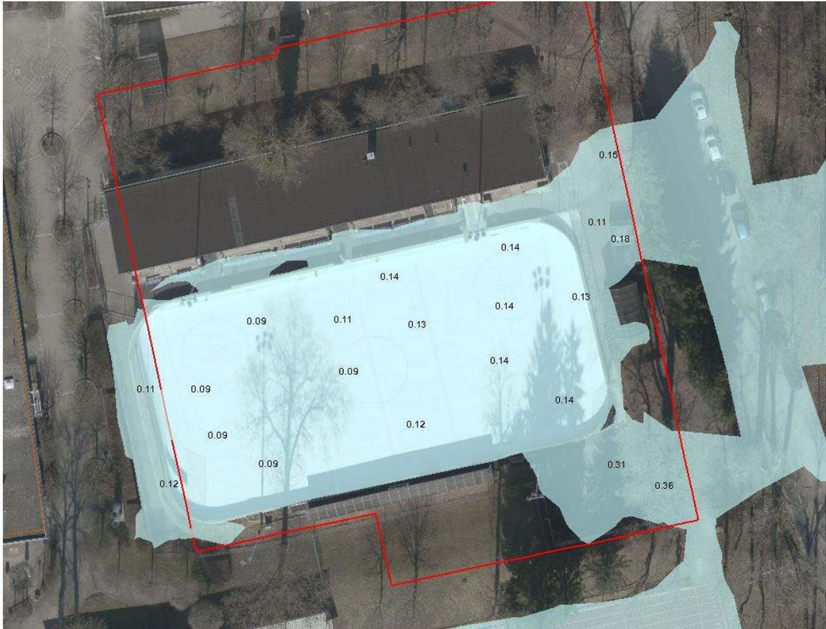
**Abbildung 4: HQ100 Ist-Zustand –Wassertiefe [m]**
