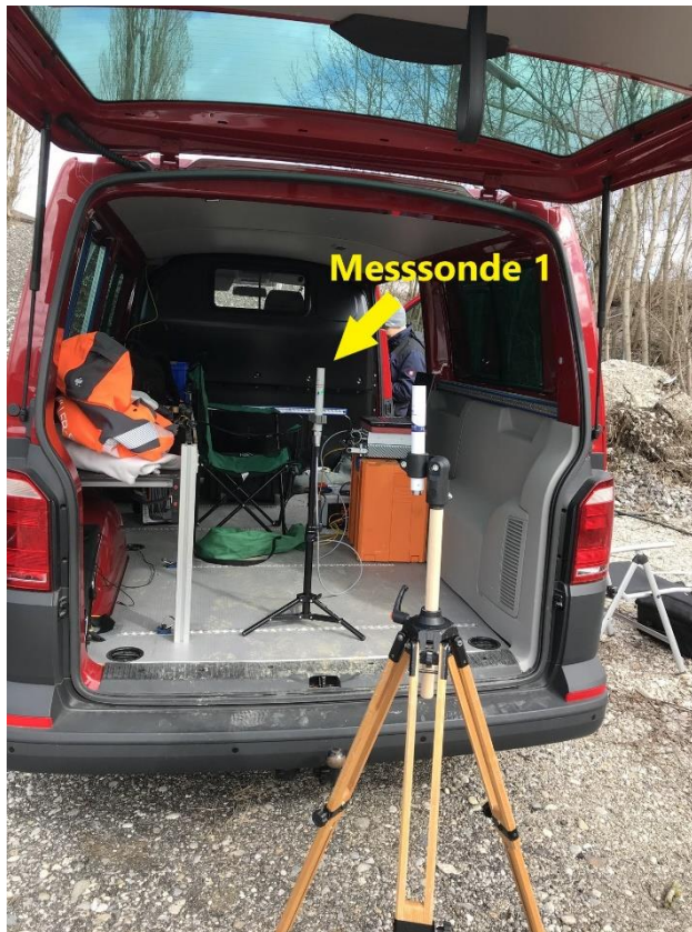
Abbildung 2. Messort S1: Langzeitmessung der magnetischen Flussdichte in einem Abstand von 21,5 m senkrecht zur Bahnsteigkante (Messsonde im Kfz).
