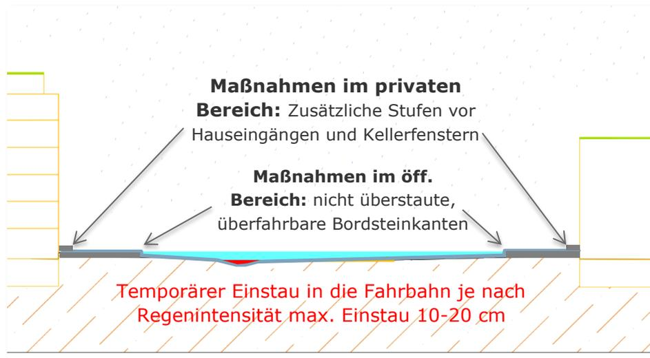
**Abbildung 30: Oberflächenentwässerung in Kombination mit Notwasserwegen durch überflutungssichere Querprofile (Prinzipskizze und Foto Esslingen Egert, RSD)**
