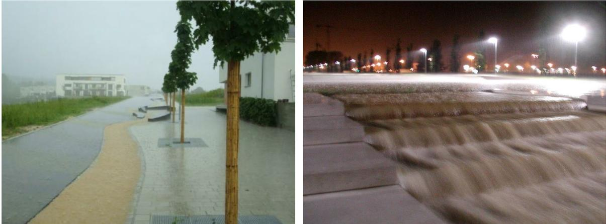
**Abbildung 34: Ableitung eines Starkregenereignis über den Querschnitt der Verkehrsflächen oder eingeplante Notwasserwege im Gelände (RSD)**
