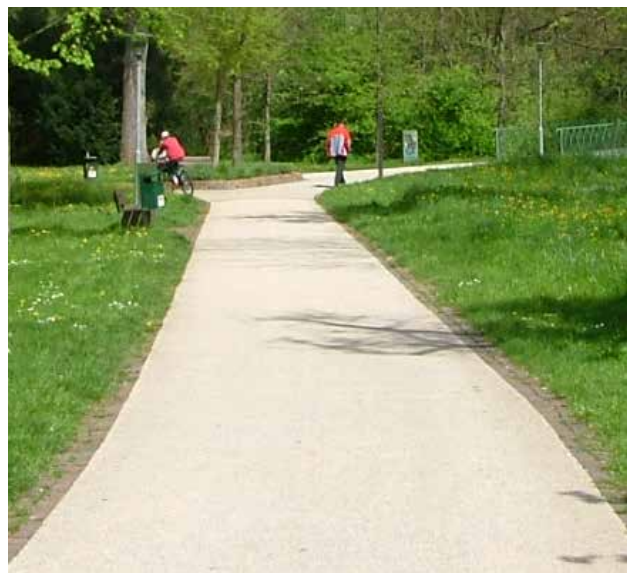
Abb. C.21.3 Wassergebundener, versickerungsfähiger Wegebelaag
