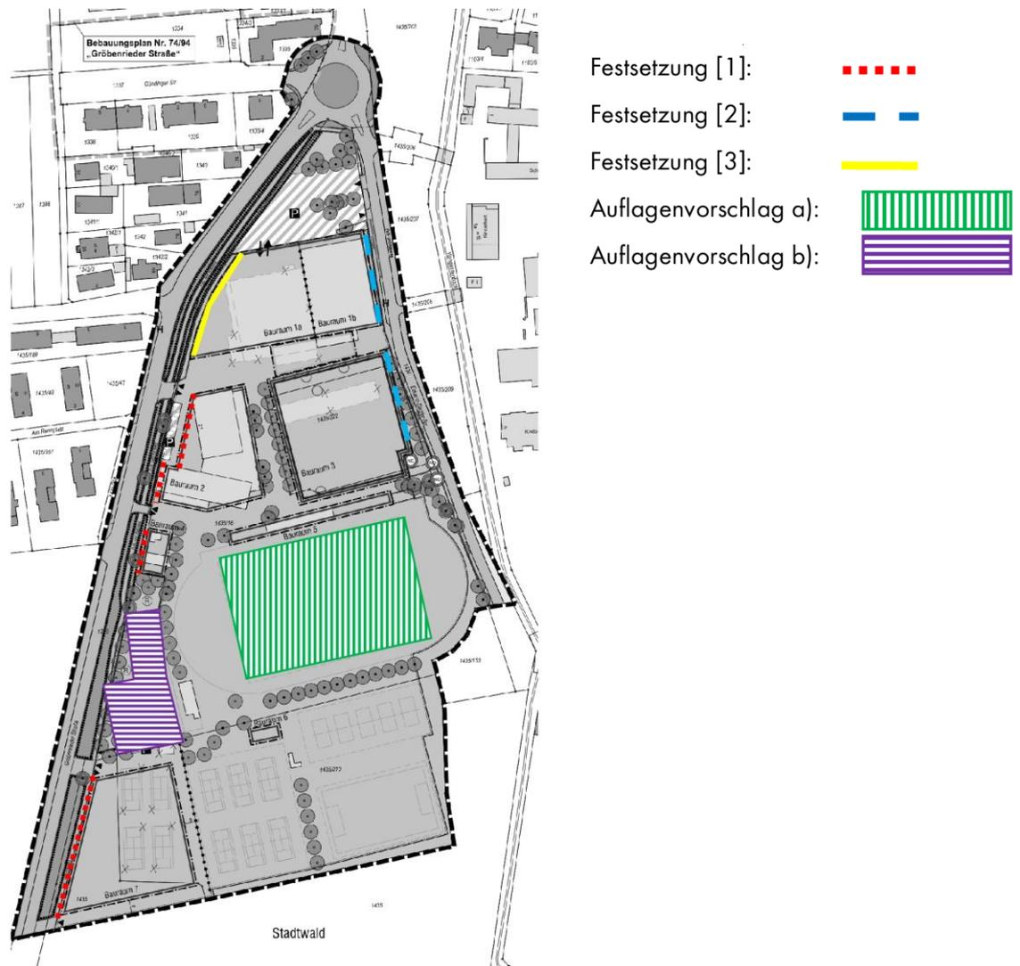
Abbildung 1: Darstellung der in den Festsetzungen und Auflagenvorschlägen beschriebenen Flächen (Quelle: Schalltechnische Untersuchung Bericht Nr. 070-6388-07, Möhler+Partner Ingenieure AG)
