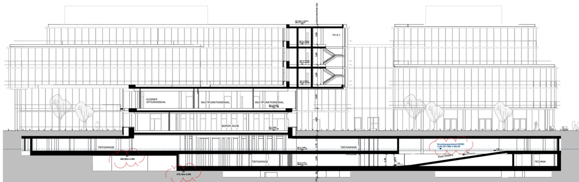
Tiefgarage Rampe UG 1 / Schnitt 5 - 5
