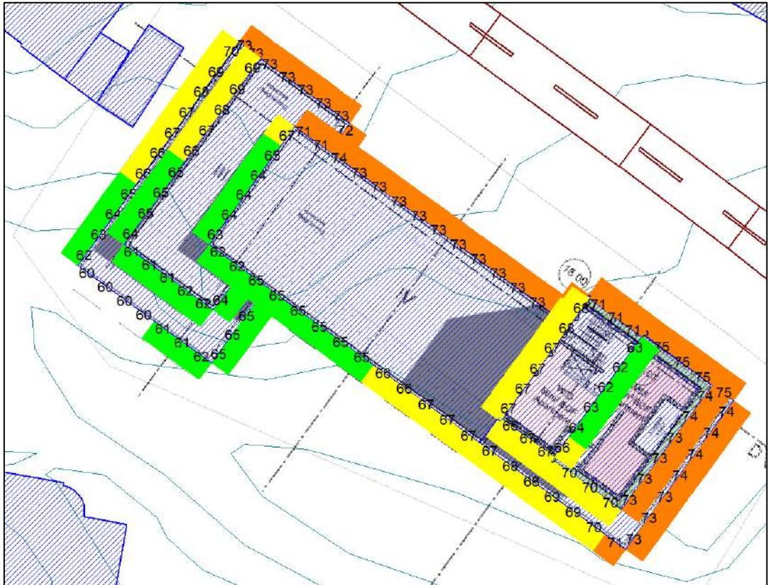
Abbildung 4. Maßgebliche Außenlärmpegel L_a nach der DIN 4109-2 von 2016 [13]:
