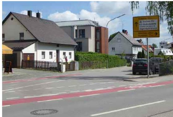
Abbildung 77: Führung des Radverkehrs mittels Angebotsstreifen auf der Fahrbahn.
