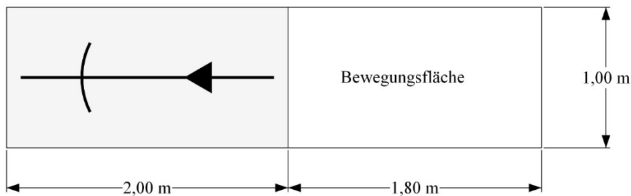
Schematische Darstellung eines Fahrradabstellplatzes bei ebenerdiger Aufstellung
