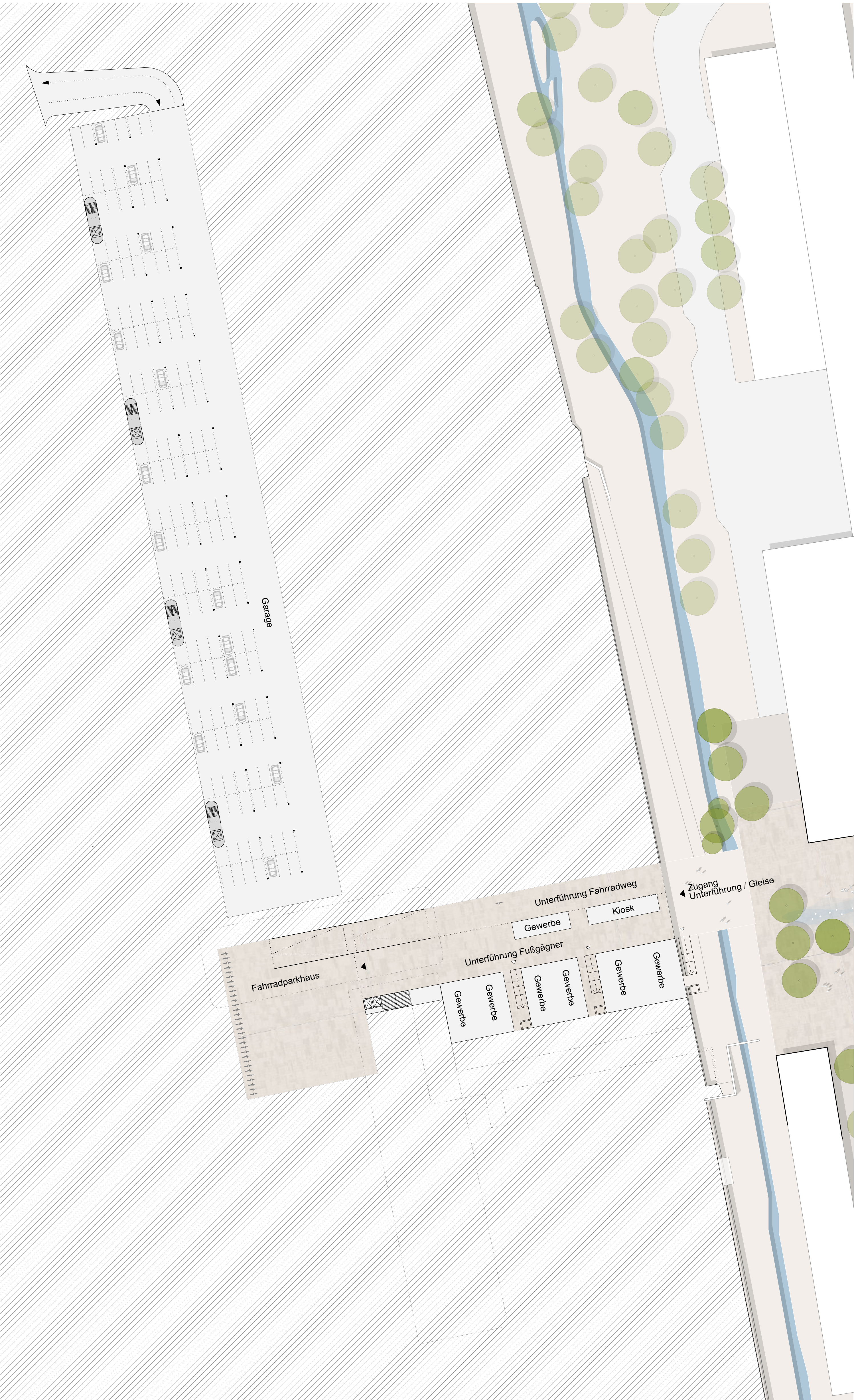
Grundriss Untergeschoss _ M _ 1:500 _ Darstellung Unterführung, Tiefgarage
