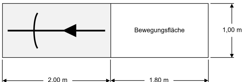
Schematische Darstellung eines Fahrradabstellplatzes bei ebenerdiger Aufstellung
