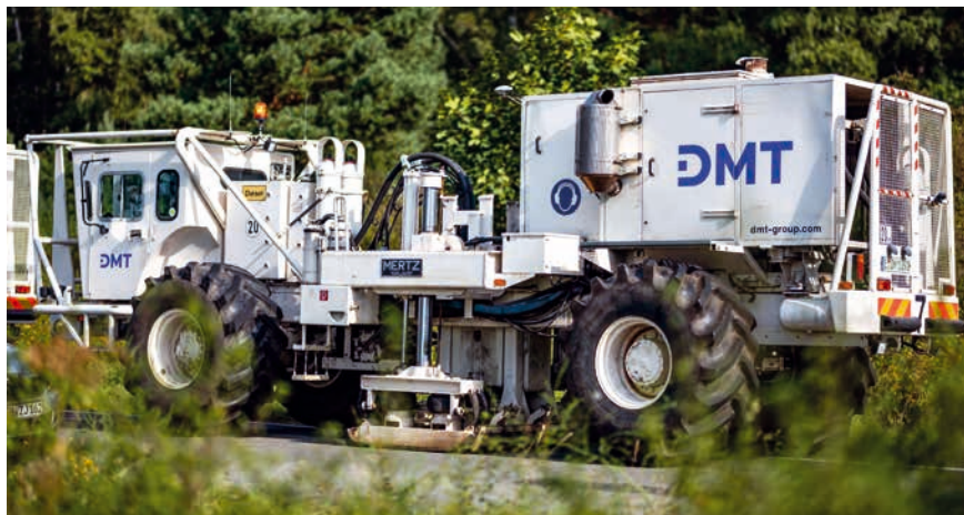
Solche Vibro-Trucks werden in Dachau im Mai zu sehen sein. Sie dokumentieren die Beschaffenheit des Untergrunds – ohne dafür bohren zu müssen.
